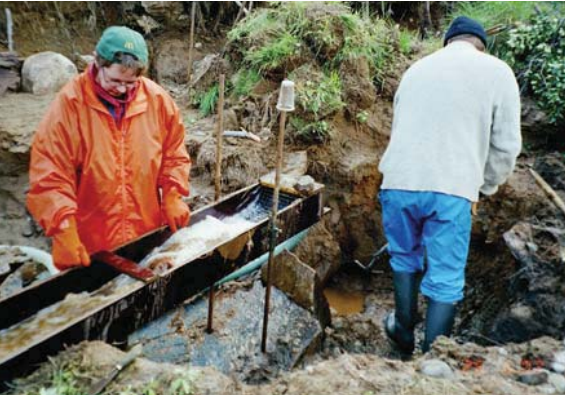
Rännin yli heitetyt tai lapiosta tippuneet kultakimpaleet saavat talteen esimerkiksi kumimaton avulla.
