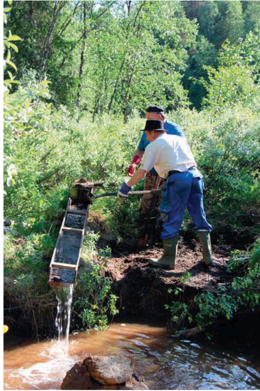
Seuraavan montun aloittaminen on helppoa. Ränni on hieman vinossa. Tutkimme, onko pintamaassa hippuja.
