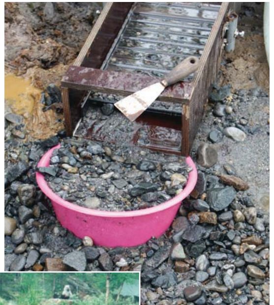
Rännin yli heitetyt tai lapiosta tippuneet kultakimpaleet saavat talteen esimerkiksi kumimaton avulla.
