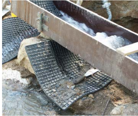
Rännin yli heitetyt tai lapiosta tippuneet kultakimpaleet saavat talteen esimerkiksi kumimaton avulla.
