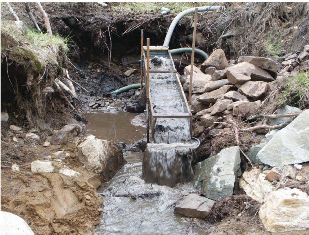
Rännitys on käynnissä kiertovedellä. Imuletku pitää monttua kuivana, ja saavi rännin alapäässä ”saalistaa” ylimeneviä hippuja, joita kuitenkaan ei ole tullut saaviin.
