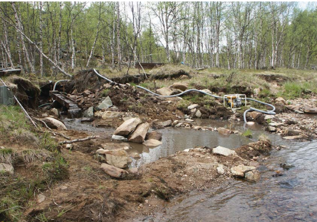
Kuvassa on toinen esimerkki padotuksen ja kiertoveden käytöstä aivan joen vieressä. Jatkuvasti etenevän montun pinta- ja ränninperämaat ohjataan edellisiin monttuihin. Mättäät siirretään täytettyjen monttujen ja heittokivikasojen päälle. Lietepumpulla kierrätetään huuhdontavesi, ja näin vieressä virtaavan joen vesi pysyy melkein kirkkaana.
