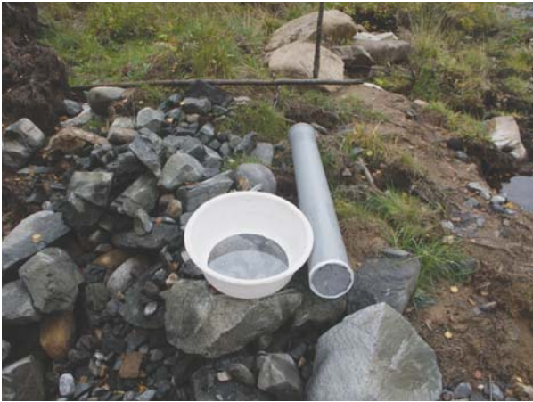
Vati ja katseluputki.
