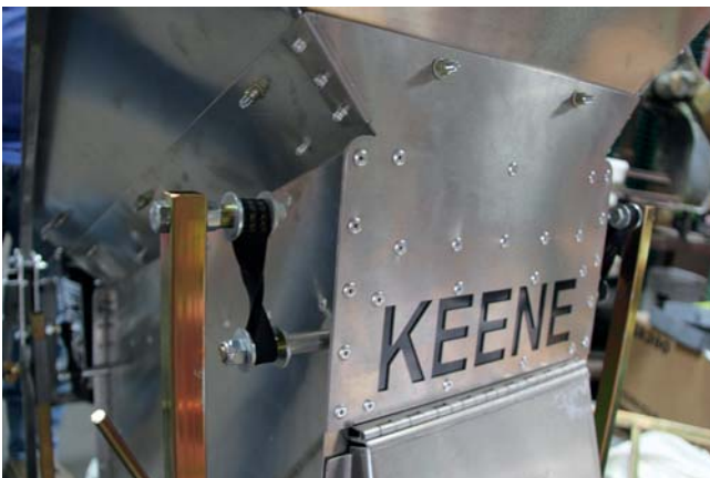
Keenen ränni on kiinnitetty telineeseen joustavalla kiinnikkeellä, ränni "tärisee" käytettäessä.
