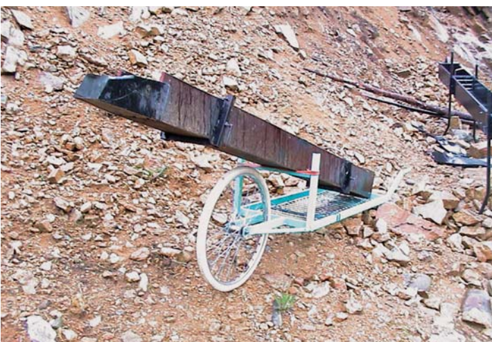
Kuljetuskärri. Iso pyörä ja painopiste alhaalla helpottavat kul- kua vaikeassa maastossa.
