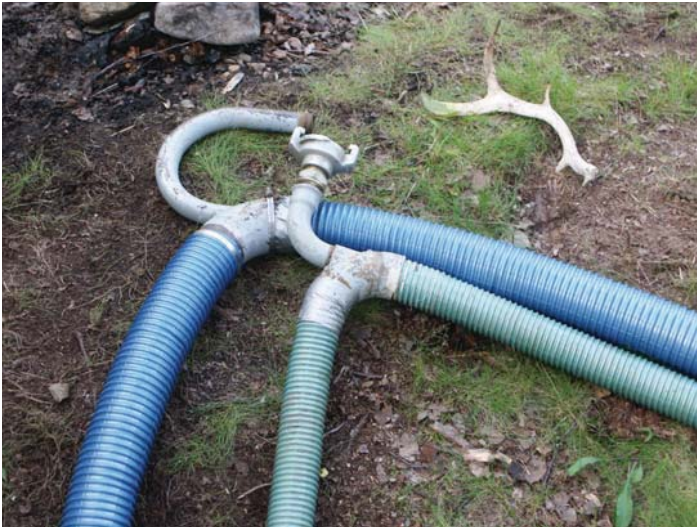
Pienezjektorit. Imuputket 50 ja 75 mm, paineputki 25 mm.
