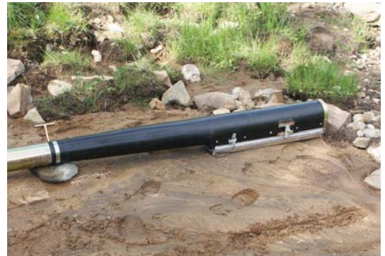
Muoviputken päässä on irrotettava rihla-laatikko kullan erottelua varten.
