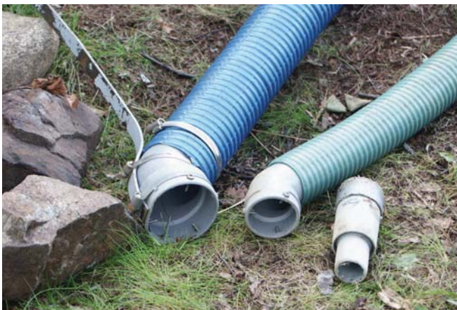
Pienimurien suukappaleita, jotka estävät isojen kivien pääsyn putkeen.
