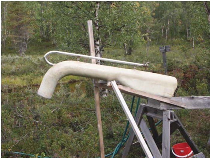
Imuri ja rihlat on rakennettu yhteen.
