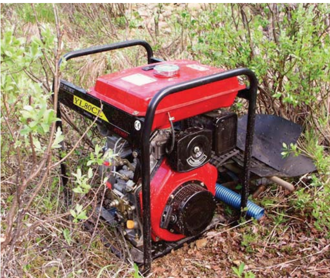
Tehokas 3" dieselpumppu, ongelmia kumiosissa.
