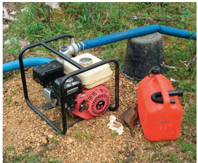
Hyvä 5,5 hv:n peruspumppu. Kuva Ismo Hellsten.
