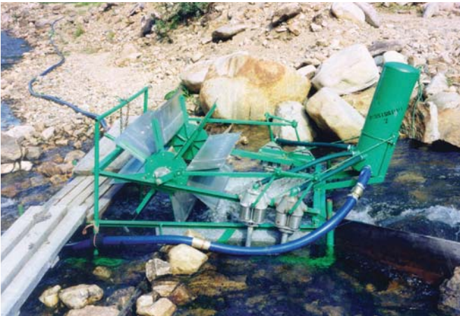
Siipirataspumppu. Ratas käyttää neljää käsipumppua.
