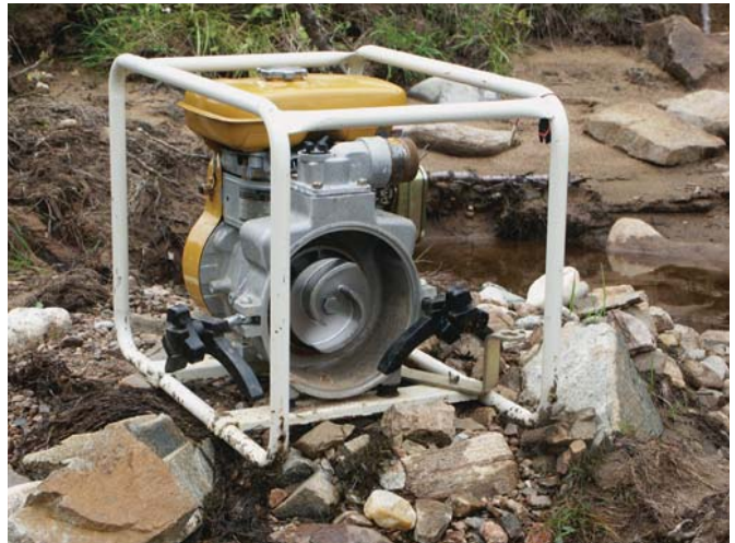
Robin E420, lietepumpun pumppu auki. Viiden kesän käytön jälkeen siipipyörä ja pumpun pesä ovat lähes uuden veroisia.
