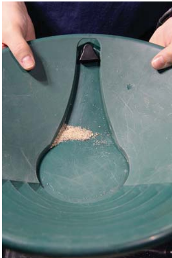
Ilmapumpun letku laitetaan vaskoolissa olevaan reikään ja jalkapumpulla puhalletaan ilmaa. Ilmavirtaus puhaltaa hiekan pois ja kulta jää näkyviin.
