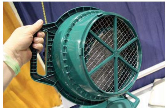
Kullan saa helposti ja turvallisesti vaskooliin kiinnitettävään kultaputkeen. Samaan reikään liitetään myös ilmapumpun letku.
