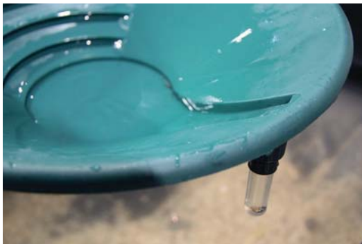
Kullan saa helposti ja turvallisesti vaskooliin kiinnitettävään kultaputkeen. Samaan reikään liitetään myös ilmapumpun letku.
