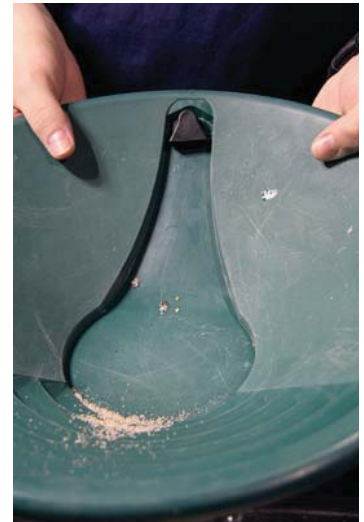
Ilmapumpun letku laitetaan vaskoolissa olevaan reikään ja jalkapumpulla puhalletaan ilmaa. Ilmavirtaus puhaltaa hiekan pois ja kulta jää näkyviin.
