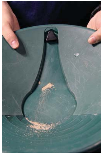
Ilmapumpun letku laitetaan vaskoolissa olevaan reikään ja jalkapumpulla puhalletaan ilmaa. Ilmavirtaus puhaltaa hiekan pois ja kulta jää näkyviin.
