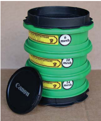
Pienoiseulat kultahippujen lajitteluun. Kuvassa vasemmalla on kolme seulaä päällekkäin, ja yhdellä kertaa saadaan hiput seulottua neljään osaan. Mittakaavana on kameran linssisuojuus. Seulan halkaisija on noin 95 mm. Suodattimen tiheys ilmoitetaan usein MESH-lukuna, joka ilmaisee, montako lankaa suodattimessa on yhden tuuman matkalla. Jos MESH-luku on esimerkiksi 60, on tuuman matkalla suodatinverkossa 60 lankaa. Aukkoja on vain 59. Erolla ei ole kuitenkaan käytännön merkitystä.
