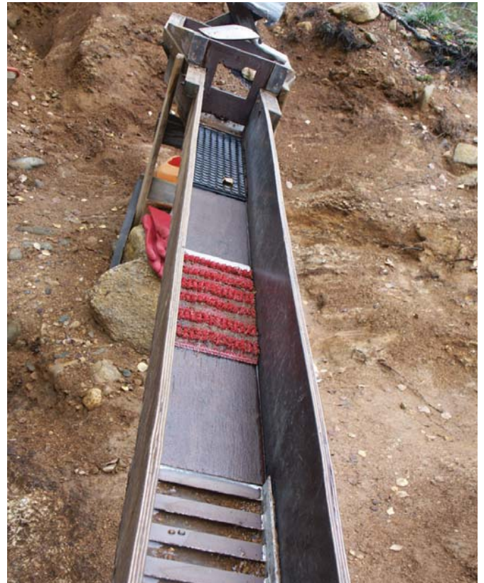
Pitkässä rännissä monta rihlaa, keskimmäinen "muovinen kynnysmatto".
