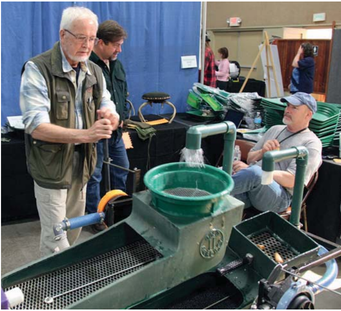
Vasemmanpuoleinen ränni heiluu sivusuunnassa pumpun tahdissa. Rännin päällä on seula ja ne heiluvat sivusuunnassa pumpun tahdissa.
