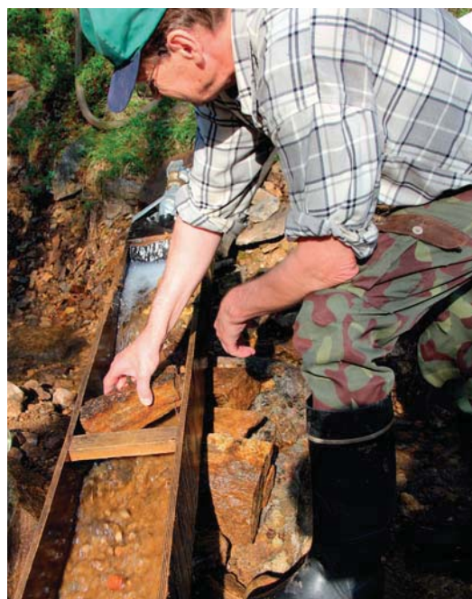
Vasen kuva: Kivieste muodostaa rännin alkupäähän pesualtaan.
