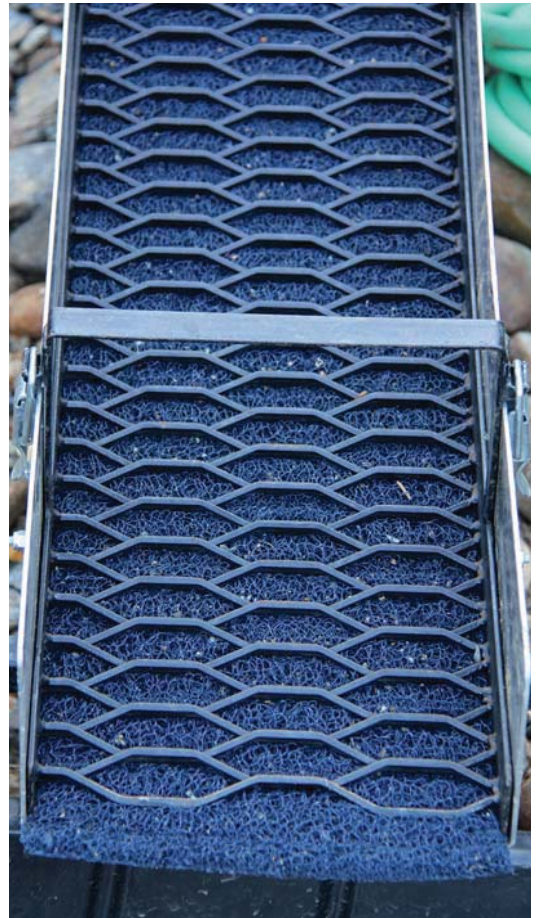
Nomen matto rännissä ja päällä salmiakkiteräsverkko. Tämä on yleisin ja helpoin tapa käyttää Nomen mattoa.
