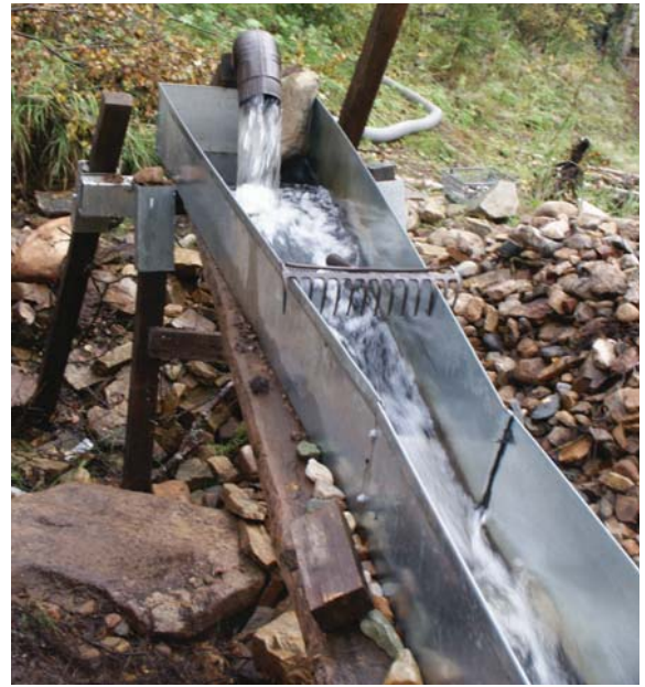
Metalliränni vapaalla virtauksella.
