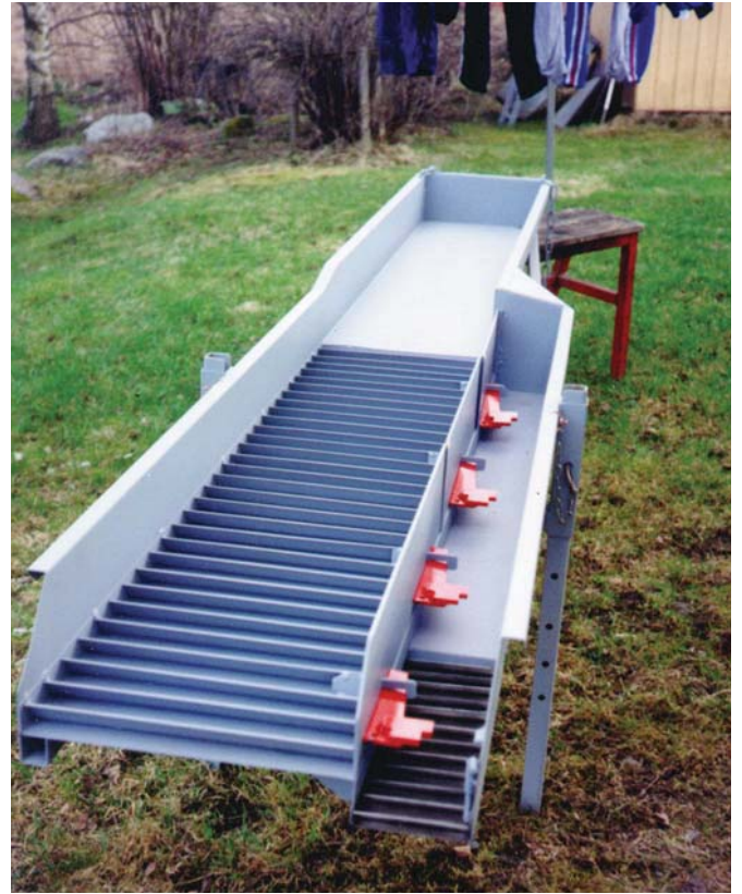
Pienen kaivinkoneen ränni.
