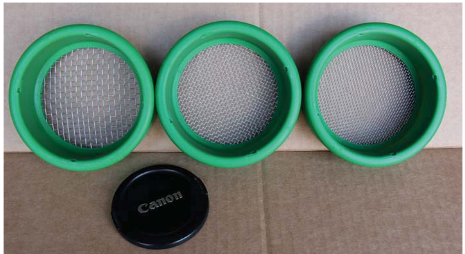
Pienoiseulat kultahippujen lajitteluun. Kuvassa vasemmalla on kolme seulaä päällekkäin, ja yhdellä kertaa saadaan hiput seulottua neljään osaan. Mittakaavana on kameran linssisuojuus. Seulan halkaisija on noin 95 mm. Suodattimen tiheys ilmoitetaan usein MESH-lukuna, joka ilmaisee, montako lankaa suodattimessa on yhden tuuman matkalla. Jos MESH-luku on esimerkiksi 60, on tuuman matkalla suodatinverkossa 60 lankaa. Aukkoja on vain 59. Erolla ei ole kuitenkaan käytännön merkitystä.
