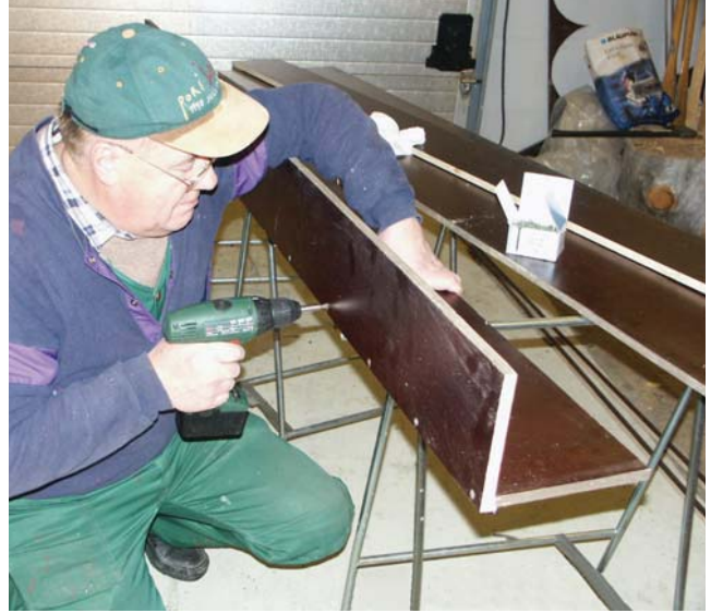
Kiinnitä laidat pohjalevyyn sivulta ruuveilla. Näin pohja ei irtoa eikä rakoile reunoista, kun ränniin lapioidaan painavia kiviä. Poraa ruuvinreiät. Käytä vain ruostumattomia ruuveja. Ruostuneita ruuveja on vaikea saada pois ränniä korjattaessa.
