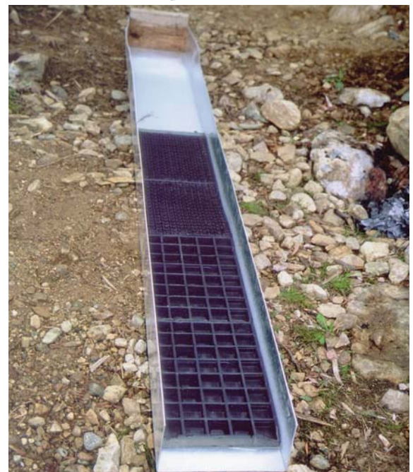
Kevyt alumiiniränni ja kumimatot.
