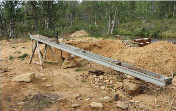
Leveä metalliränni. Huomaa melko jyrkkä kaatokulma. Tämän rännin käyttäjän mukaan isot kivet juoksevat alas auttamatta.
