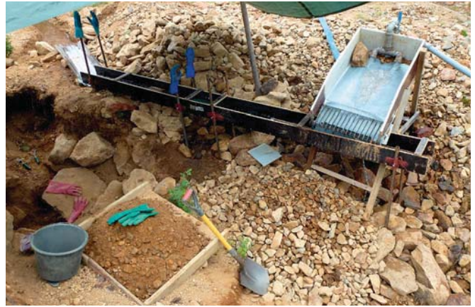
Sivuheittolaatikko vapaavirtauksella toimii kivien pesu- altaana. Kuva Ismo Hellsten.
