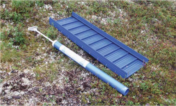
Kevyt muoviränni koehuuhdontaan. Pohja on muotoiltu eri kokoisiksi rihloiksi. Imupumpulla otetaan näytteitä joen pohjasta.
