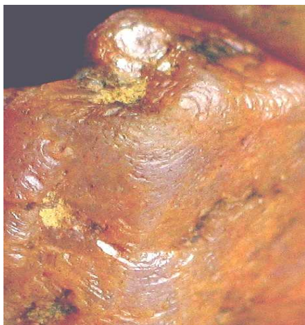
Kuva 25. Tyypilliset parting tasot korundin pinnassa
